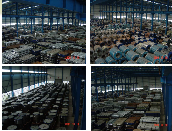
某仓库地面堆载情况
